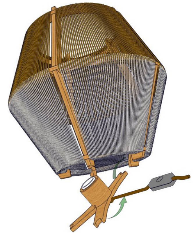
1. Leuchtmittelhalter von unten in den Leuchterschirm „einfädeln“.
